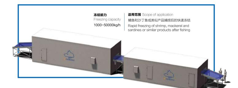
盐水淋浴冻结系统是一种紧凑和高性能的快速冻结系统,在渔业方面是最理想的用于虾、银鱼、小鱿鱼和沙丁鱼或类似产品捕捞后的快速冻结。这些水产品装在带孔的框内通过一段隧道接受氯化钠盐水的喷淋在7-10分钟内就可把产品冻结至-12~-14℃。随后进入-35℃的空气冷冻隧道把产品进一步冻结到-18℃以下。
